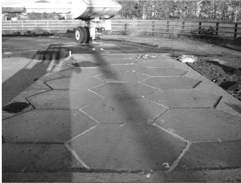
Figure 4 – Vue de l’essai sur le manège de fatigue du LCPC
