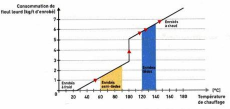
L'énergie nécessaire au chauffage d'une tonne de granulats humides n'est pas strictement proportionnelle à la température, car la transformation de l'eau de l'état liquide à l'état de vapeur consomme une grande quantité d'énergie, sans changement de température [chaleur latente de vaporisation ou enthalpie de vaporisation].
