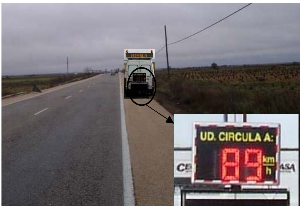
Figure 4 - Panneau mobile de renforcement de signalisation équipé de détecteurs de vitesses utilisé lors des essais pilotes (Texte : Vous circulez à : 89 km/h)
