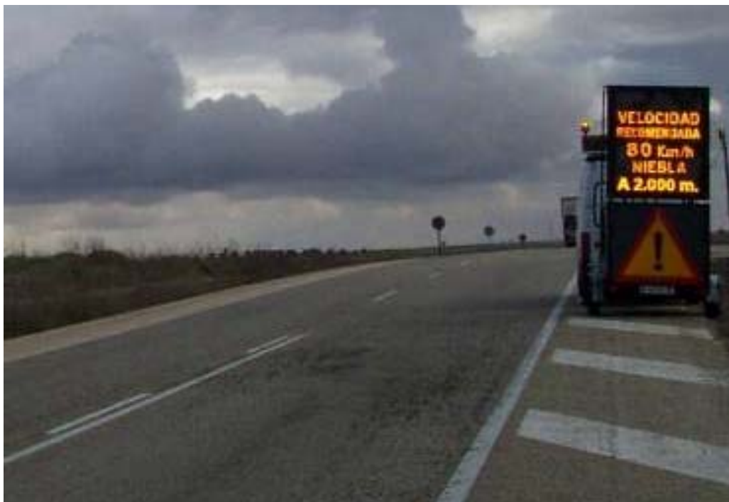
Figure 3 – Panneau mobile de signalisation d'avertissement utilisé lors des essais pilotes (Texte : Vitesse recommandée 80 km/h-Brouillard à 2000 m)
