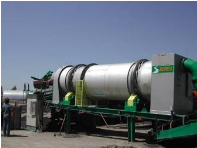
Ecomac : tambour «tiédisseur», application en couche de roulement sur route à trafic moyen, noter l'absence d'émission (crédit photo: Y. Brosseaud LCPC)
