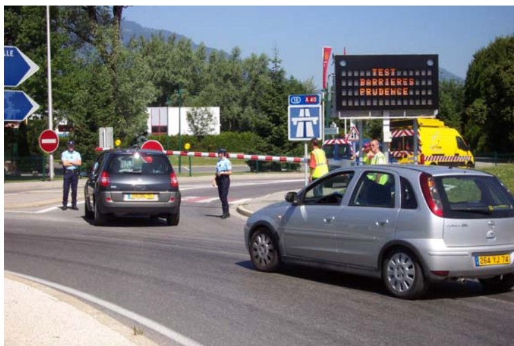
Activation des Panneaux d'information sur Accès (PIA) et fermeture des accès par barrières pour un cantonnement immédiat.
