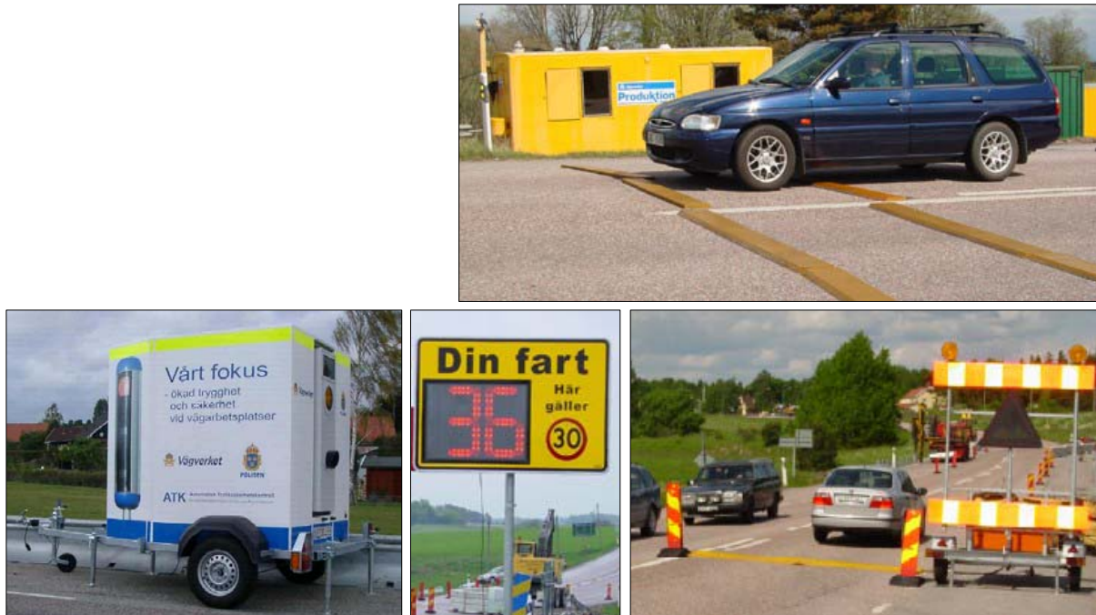
Figure 1 - Produits testés. Mini ralentisseur (en haut à droite), radar mobile (en bas à gauche), affichage de vitesse (en bas au centre) et mini ralentisseur actif (en bas à droite sans feux clignotants).
