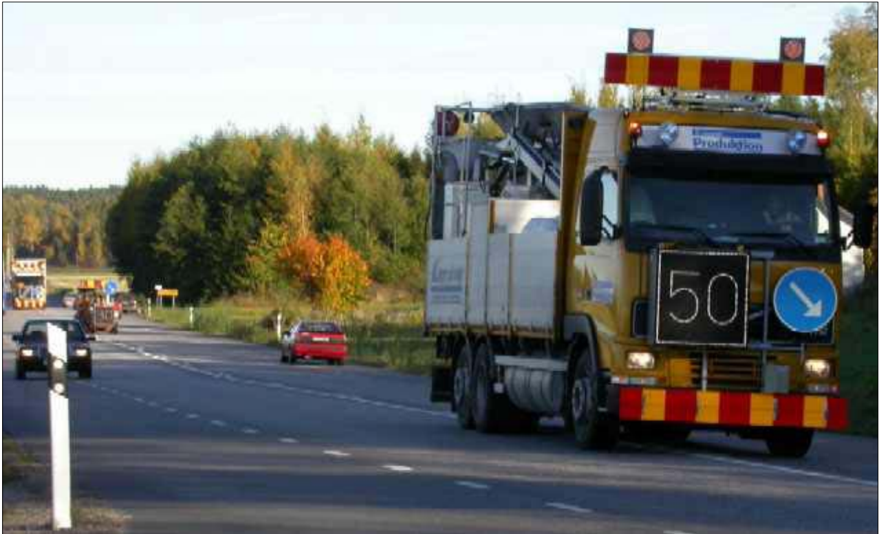
Figure 10 - Panneaux (numériques) à LED montés sur camion, affichant la vitesse recommandée durant les opérations de marquage au sol. Enköping, 50 km au nord-ouest de Stockholm, 2005. Noter l'équipement radar blanc (type SR3+) monté sur le véhicule.
