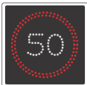
Figure 7 - Exemple de PMV. Les pixels du panneau peuvent être produits en utilisant la fibre optique ou des diodes électroluminescentes. Ce panneau à LED a été utilisé dans le cadre du projet, par exemple, pour évaluer l'impact qu'a un PMV affichant la vitesse recommandée.
