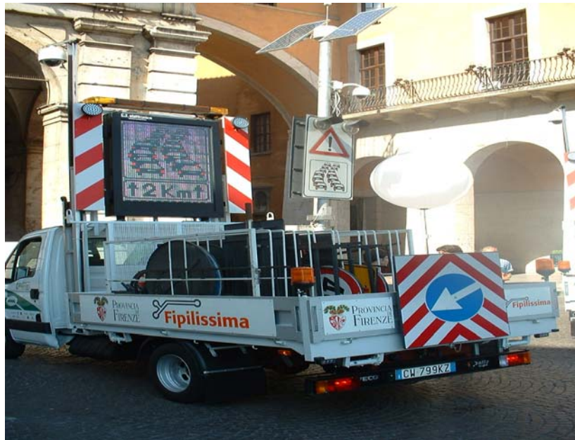
“Figure 3 – Détail du panneau à messages variables sur une camionnette”
