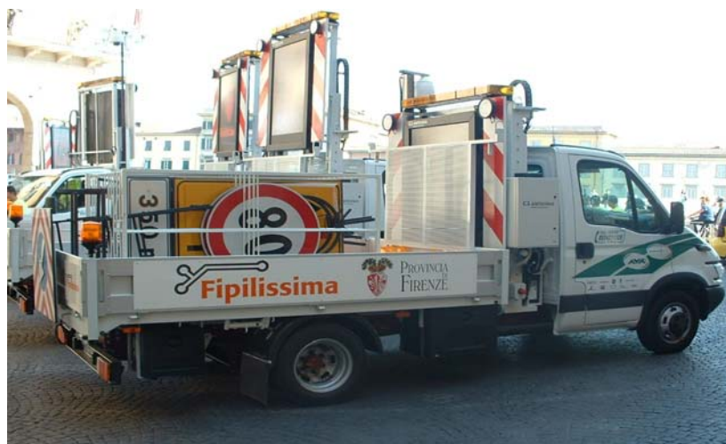
“Figure 2 : Camionnette équipée pour la surveillance et les interventions d'urgence“
