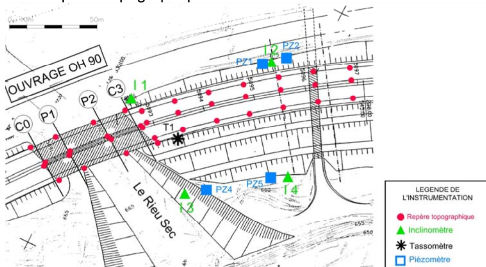
Figure 6 - Implantation des sondages et repères topographiques sur le secteur du Rieu Sec.
