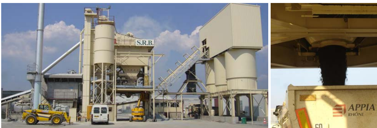
Figure 5. Aucune émission de fumée pendant la décharge du mélange dans les camions.
