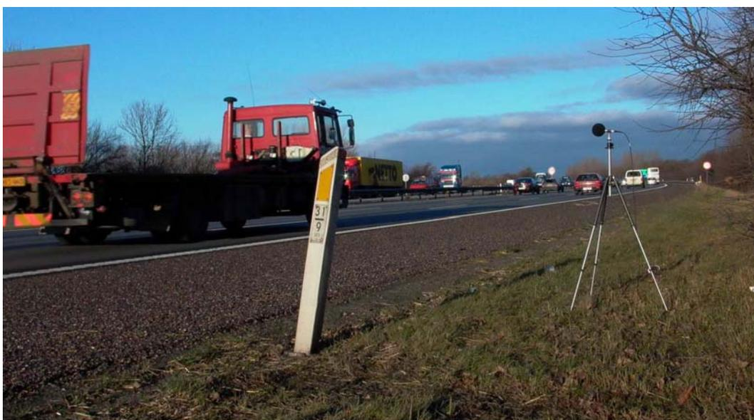
Figure 13 - Installation typique de microphone sur les mesures de bruit SPB sur les sections-test sur la M10.
