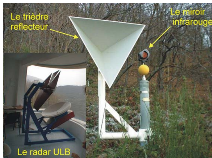
Figure 9 – Les mesures de distance par radar : à gauche, le radar abrité dans une cabine située sur le versant sud ; un trièdre réflecteur pour le radar, à côté d'un miroir pour la mesure par infra-rouge
