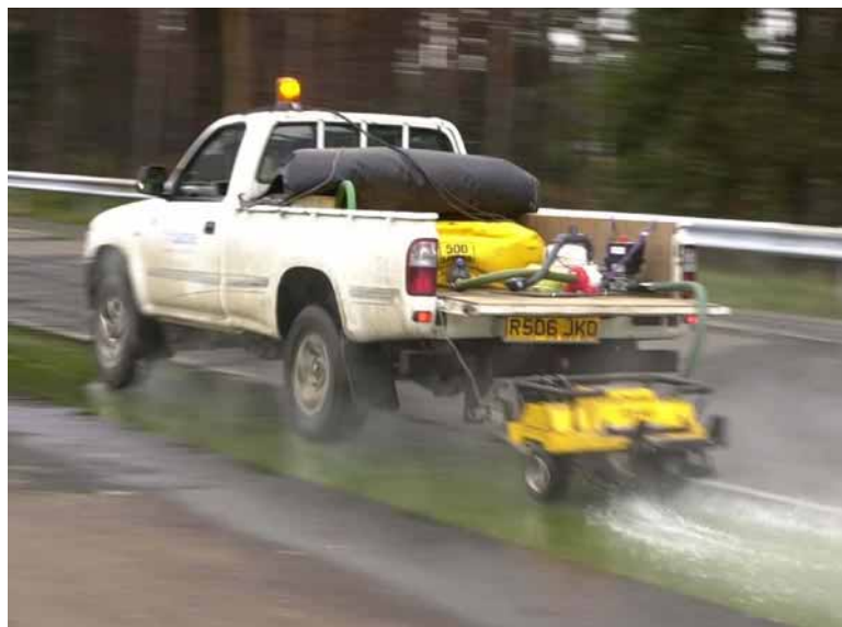
Figure 7 – Essai de glissance sur route mouillée.
