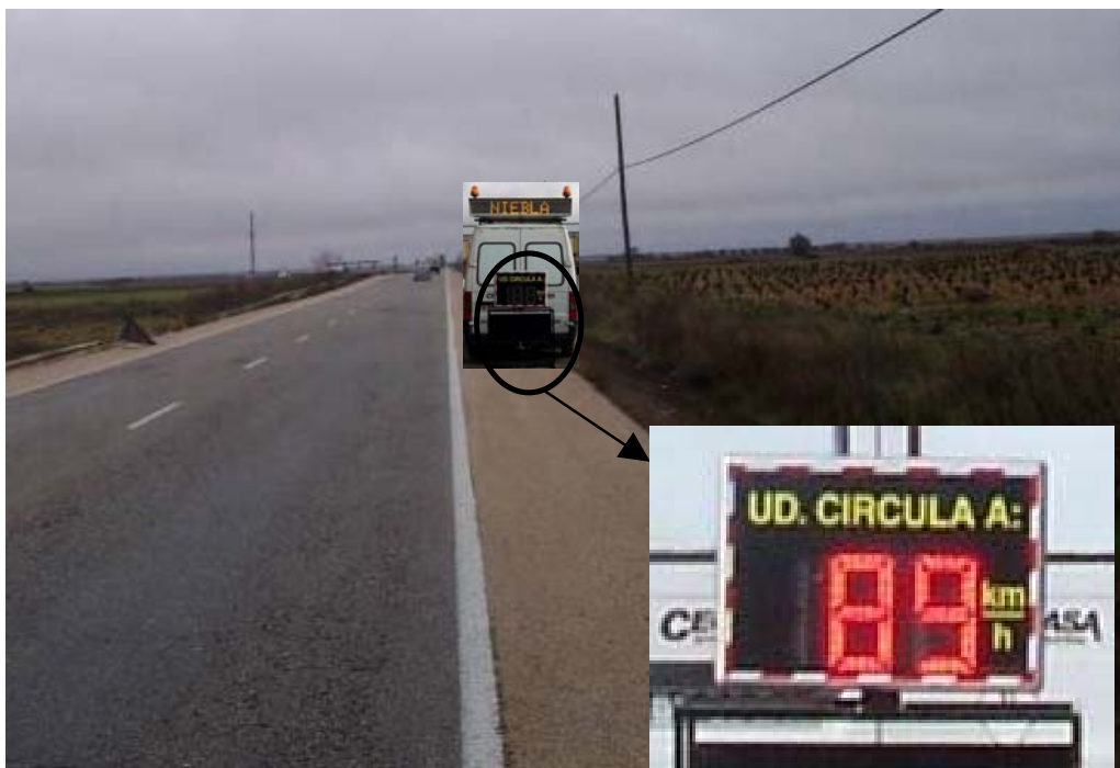
Figura 4 - Panel móvil de señalización de refuerzo equipado con detector de velocidades empleado en las pruebas piloto
