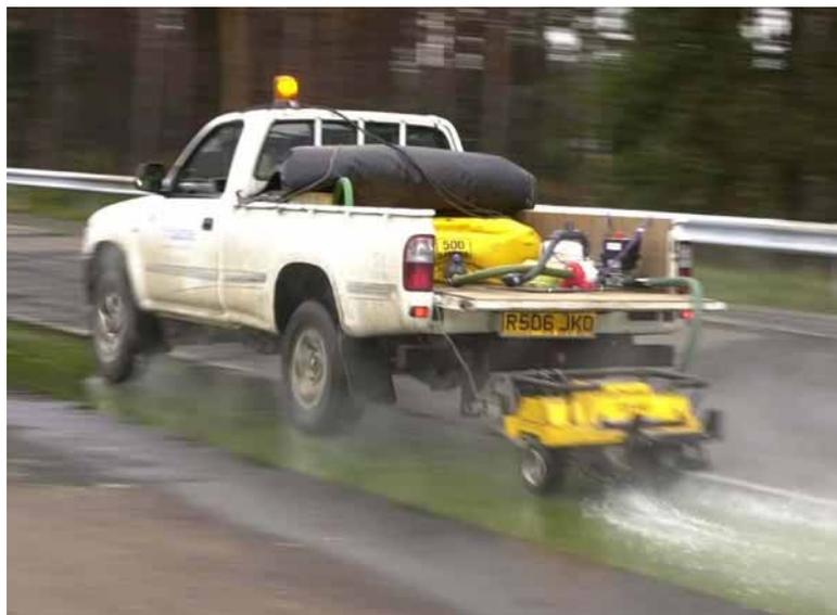
Figura 7 – Ensayo de resistencia al deslizamiento en condiciones húmedas
