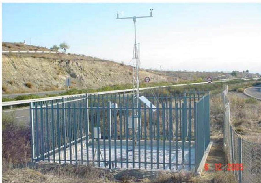
Figura 7- Estación meteorológica para gestión de vialidad invernal colocada en Lorca
