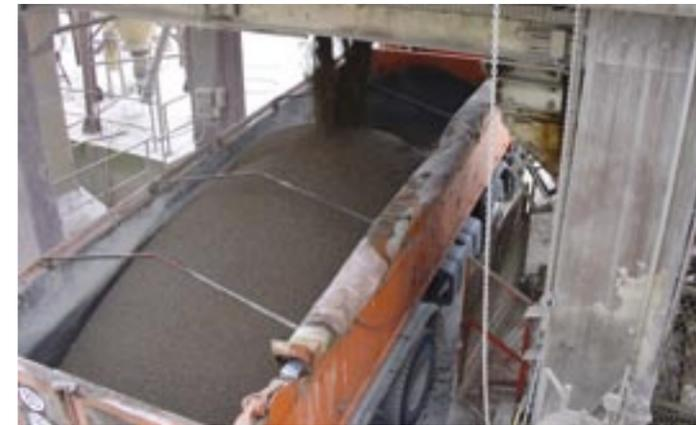
Photo 3 : Chargement d'un camion à la centrale de fabrication
