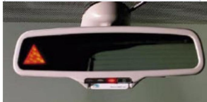
du trafic et le consulte sur la marche appropriée à suivre. Le système comprend des dispositifs acoustiques, visuels et tactiles (équipement avec vibration). Le système fournit plusieurs niveaux d'alerte selon l'estimation du niveau de risque et le niveau estimé de vigilance du conducteur ;
